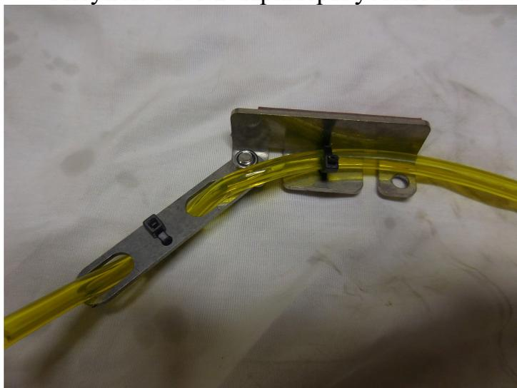
Рисунок 1.3. Прокладка трубки в держателе форсунки.
