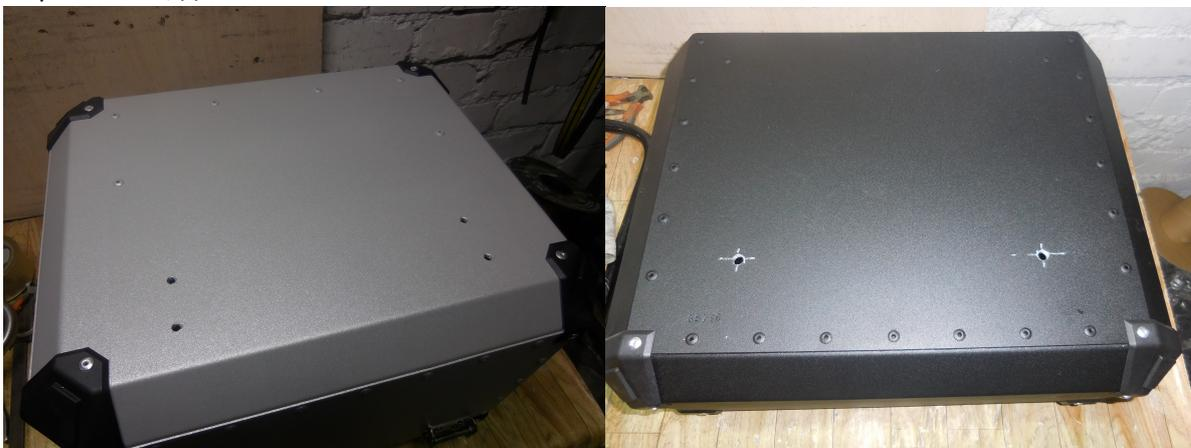
3. Установить опоры (вилки). Опоры для боковых кофров уставить в положении, соответствующем диаметру багажных рамок на мотоцикле (16мм либо 18мм).
