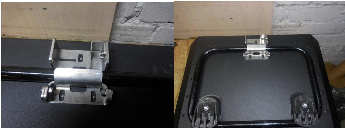
5. При установке замка шайбу меньшего диаметра необходимо установить согласно отметке на изображении. На данном этапе производится регулировка положения замка.
