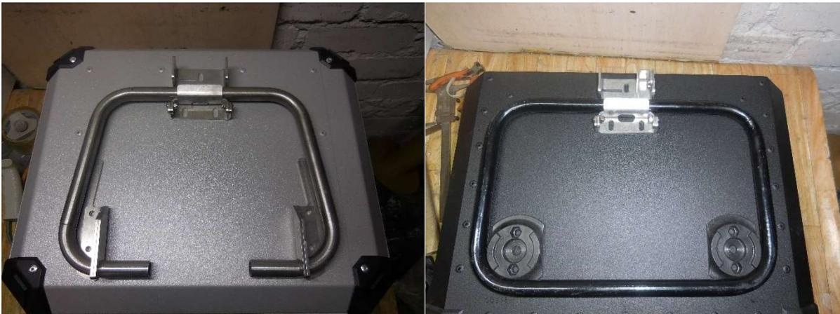
2. Произвести разметку отверстий для опор (вилок для центрального кофра). Для опор диаметр сверла 8.5мм, для вилок – 6.5мм.
