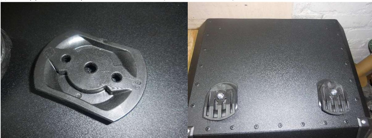
4. Произвести примерку замка и разметить отверстия его крепления. Диаметр отверстий 6.5мм.
