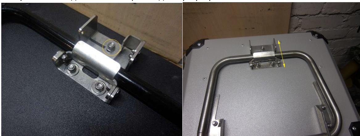
6. Установить пружину на направляющую. Винты крепления запирающей защелки затягиваются с моментом 3.8 N.m. и затем отпускаются в обратном направлении на 45 градусов, для обеспечения необходимого зазора в подвижном соединении.
