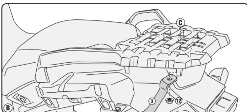
Обжать болтовые соединения усилием: M6 – 10.5 Нм, M8 – 25 Нм,
