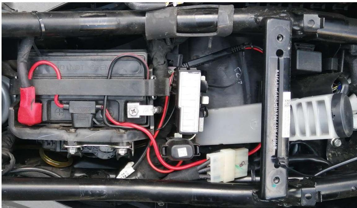
Фотография 1.6. Подключение автосмазчика к АКБ мотоцикла.
