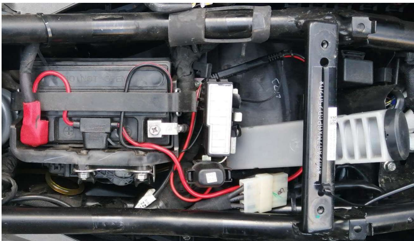
Фотография 1. Подключение автосмазчика к АКБ мотоцикла
