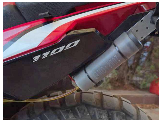
Фотографии 2 - 5. Примеры установки блока автосмазчика
