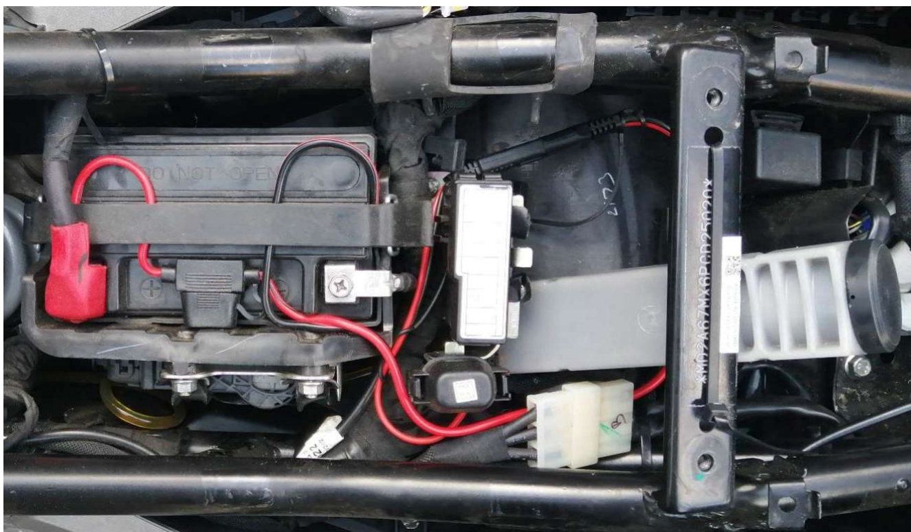
Фотография 1. Подключение автосмазчика к АКБ мотоцикла
